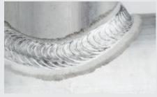
/ Mit der standardmäßig für alle TPS/i Geräte verfügbaren Funktion SynchroPuls kann eine mit einer WIG-Schweißnaht vergleichbare Nahtoptik erzielt werden. Ein optisch perfektes Nahtaussehen ist garantiert.
