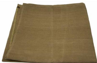
En fibre de verre, revêtement anti-glissant. Résistant sur les 2 faces à 900 °C en continu et 1'150 °C en pointe. Protection contre les étincelles, éclats de soudage et meulage. Résistance mécanique et au coupage.
