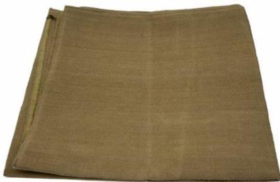
Spritzerschutzdecke aus E-Glasgewebe mit HT-Beschichtung. Dauerbelastbar bis 900 °C, kurzfristig bis 1'150 °C. Beständig gegen Öle, Fette, organische Säuren, Lösungsmittel, Wasser und mechanische Belastungen.
