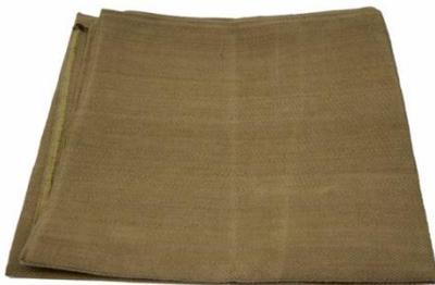
Spritzerschutzdecke aus E-Glasgewebe mit HT-Beschichtung. Dauerbelastbar bis 900 °C, kurzfristig bis 1'150 °C. Beständig gegen Öle, Fette, organische Säuren, Lösungsmittel, Wasser und mechanische Belastungen.
