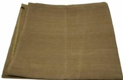
En fibre de verre, revêtement anti-glissant. Résistant sur les 2 faces à 900 °C en continu et 1'150 °C en pointe. Protection contre les étincelles, éclats de soudage et meulage. Résistance mécanique et au coupage.
